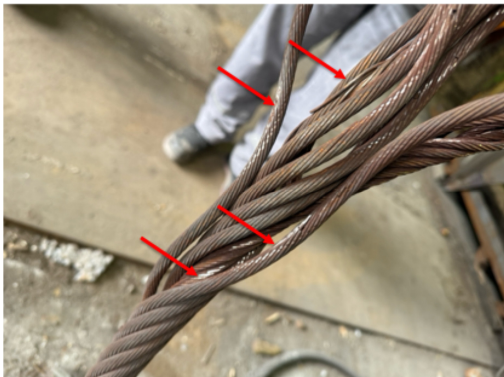
Bild 8.2: manuell aufgedrehter Seilabschnitt
